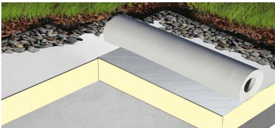
Le membrane KÖSTER TPO possono essere installate liberamente (senza ancoraggi) sotto i tetti verdi, il giardino sovrastante serve da zavorra e protegge la membrana dal carico del vento. Inoltre, le membrane KÖSTER TPO sono resistenti alla penetrazione di radici e rizomi. Questo permette di piantare e coltivare direttamente sopra la membrana.
